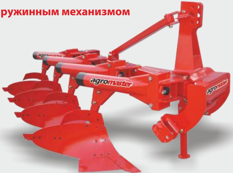
Плуг, предназначенный для первичной (основной) обработки почвы, устанавливается на гидравлическое подъемно-навесное устройство трактора с помощью универсальной трехточечной системы подвески, что обеспечивает легкую транспортировку плуга до поля.
