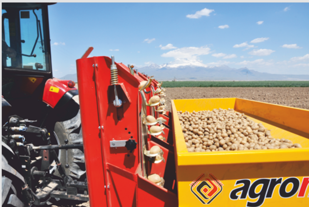
Adjustable seed distance by interoperated gears. Регулируемое расстояние посева семян (клубней) с помощью взаимодействующих передач.
