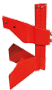
Clod and lump cleaner to clear out obstacles before coulters passes / Устройство для удаления камней и комков земли позволяющее отодвигать препятствия перед прохождением сошника
