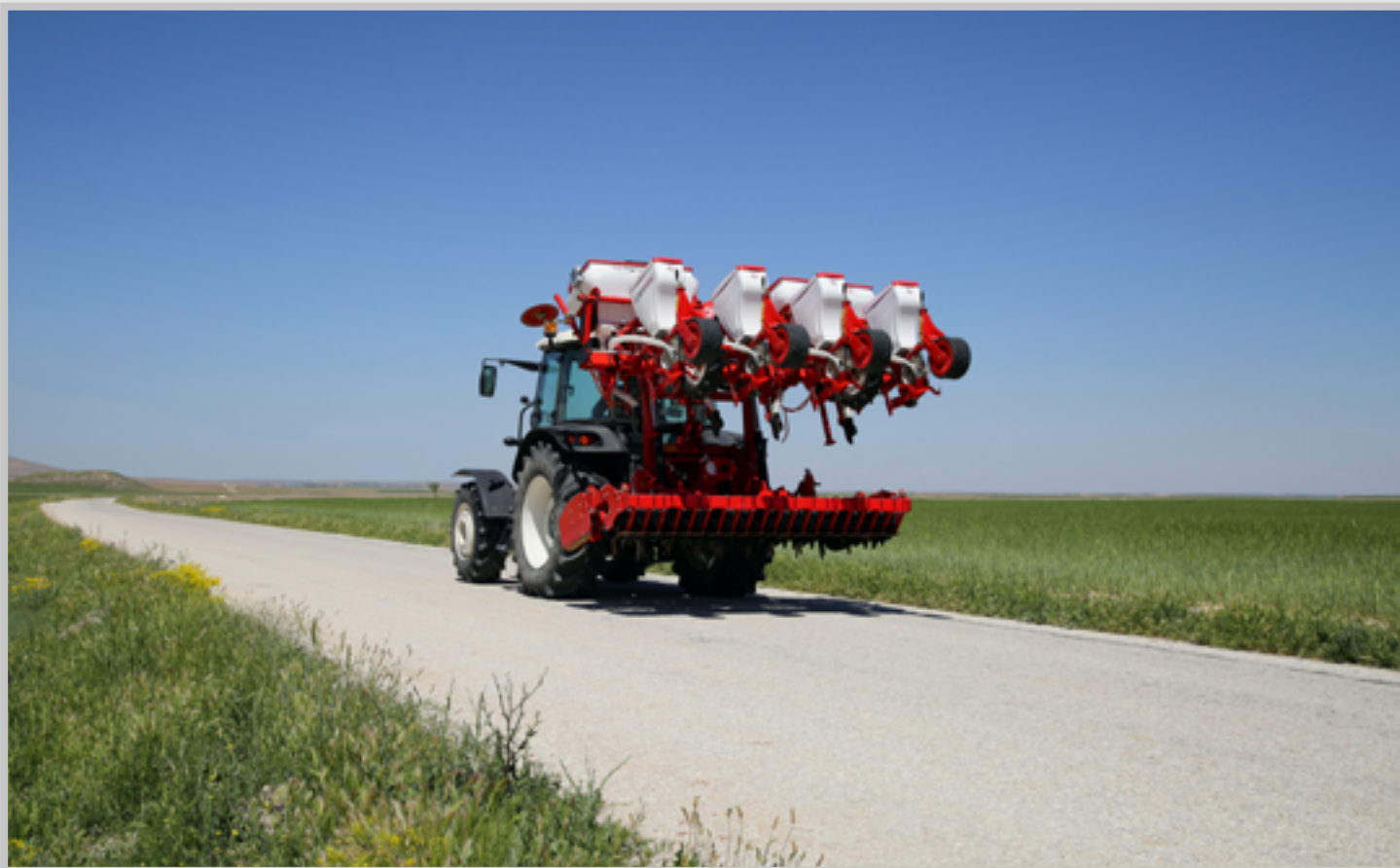
Otiflex rear roller for pressing down and closing seed beds / Задний каток Отифлекс для уплотнения почвы и последующего закрытия посевного ложа
