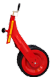
Otiflex rear roller for pressing down and closing seed beds / Задний каток Отифлекс для уплотнения почвы и последующего закрытия посевного ложа
