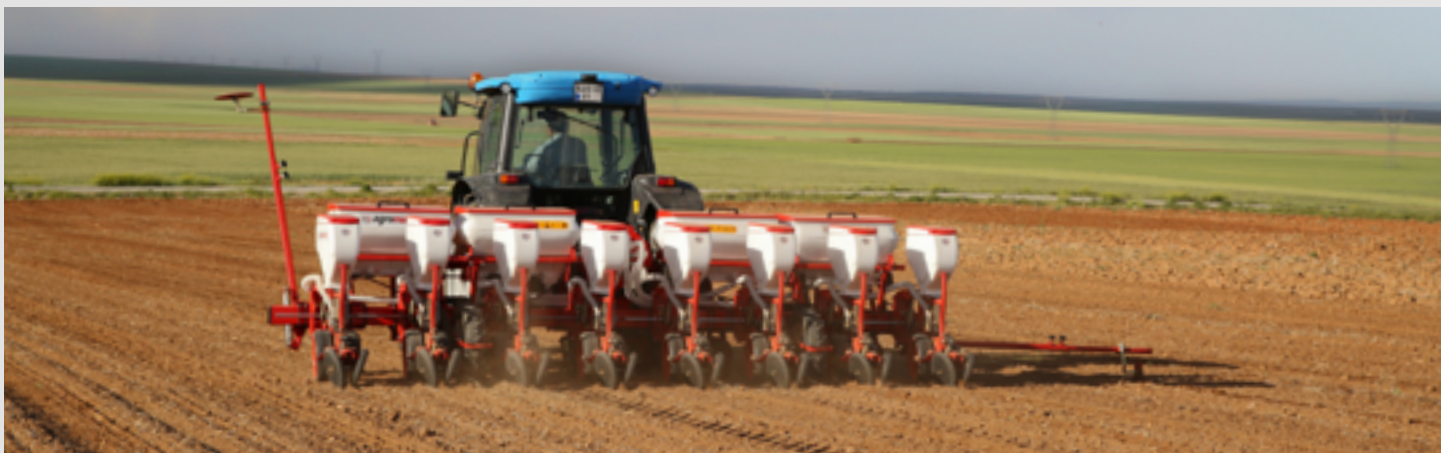
Otiflex rear roller for pressing down and closing seed beds / Задний каток Отифлекс для уплотнения почвы и последующего закрытия посевного ложа
