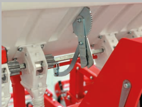
Lid system discharge all fertilizer in the hoppers. / Система крышки для сброса всего удобрений в бункерах.
