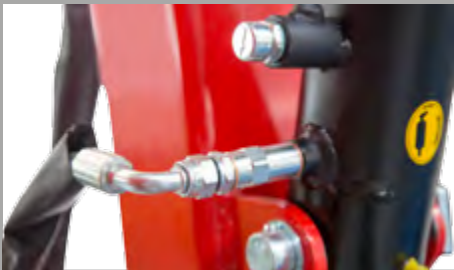
Safety valve Предохранительный клапан
