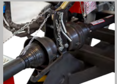
High maneuverability with adapter power transfer shaft / Высокая маневренность с помощью переходника между карданами
